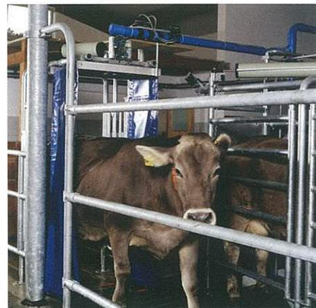
Eingangsbereich mit Haupttor und Portalantenne – Zentral gesteuertes Eintrien und sichere Erkennung.
