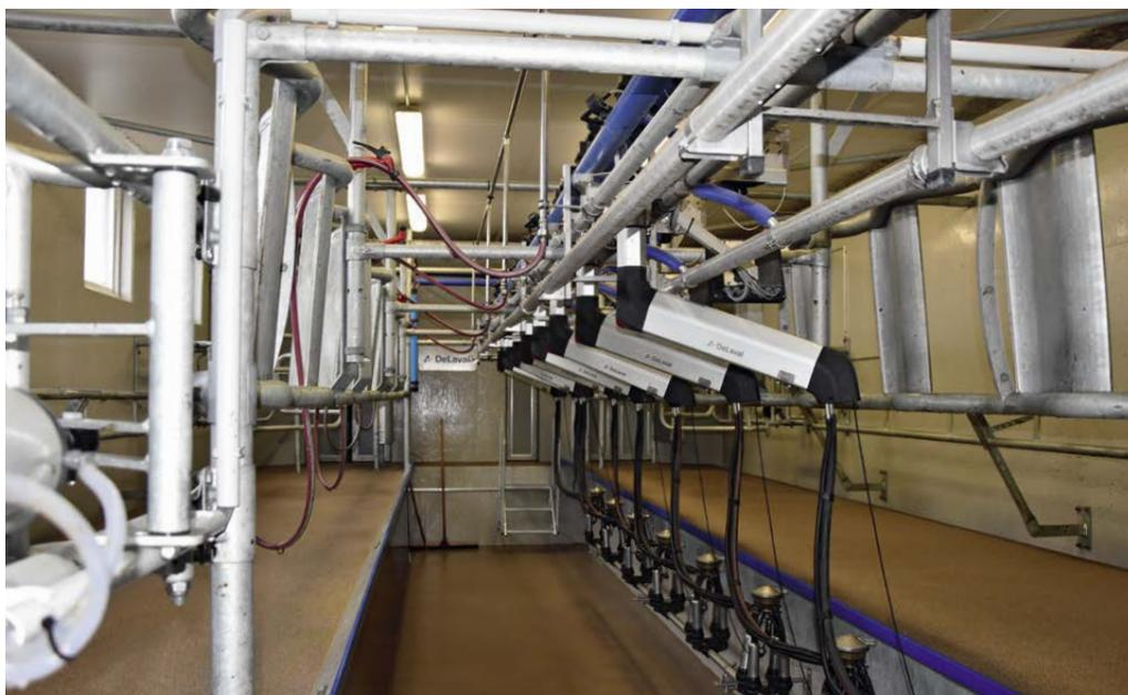
Fischgrätenmelkstand 50° MidiLine™ ML3100 mit Melkplatzkontrollern MPC680. Die Melkzeuge sind an einem freitragenden 2" Gerüst hoch im Melkstand montiert in sauberer und trockener Umgebung.
