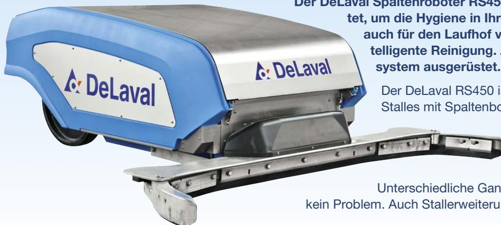
Der DeLaval Spaltenroboter RS450 ist mit einer Vielzahl von Funktionen ausgestattet, um die Hygiene in Ihrem Stall zu verbessern. Für die Laufgänge und auch für den Laufhof verspricht der RS450 eine professionelle und intelligente Reinigung. Alle Spaltenroboter sind mit einem Wassersprühsystem ausgerüstet.
