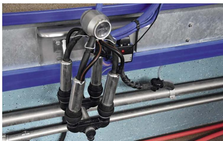
Komfort für Kuh und Melker: Das robuste Melkzeug MC73 aus Edelstahl mit der innovativen Top Flow Technologie ermöglicht einen schnellen und ungestörten Milchfluss aus dem Sammelstück.
