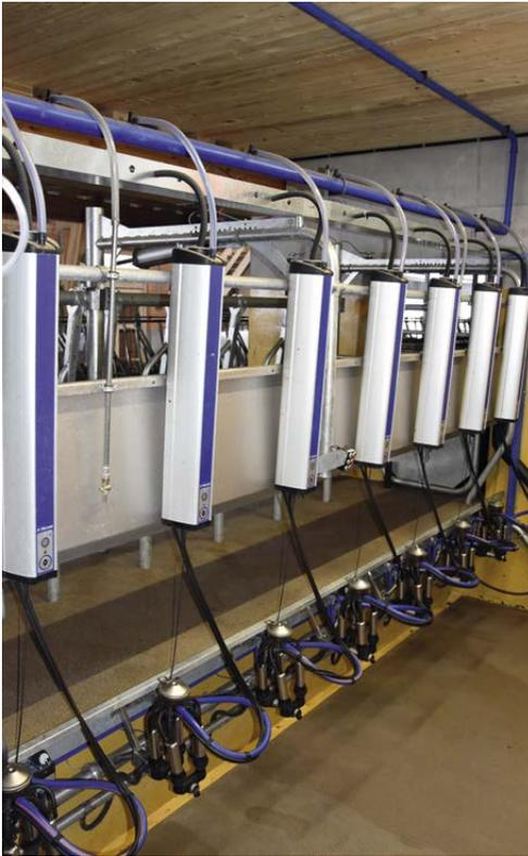
Melkstand P2100: Robuste Struktur, Edelstahlkotrinne und Druckluftsteuerung für einen reibungslosen und langlebigen Betrieb.
