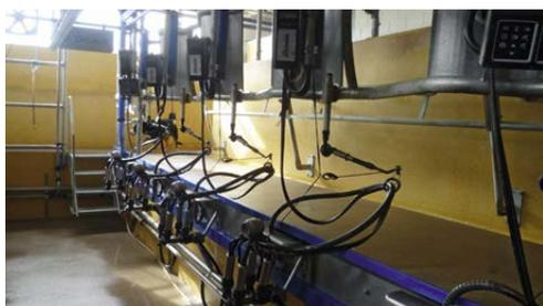
Gemolken wird in einem Fischgrätenmelkstand 30° 2x5, ausgestattet mit dem DelPro™ Herdenmanagement System und DeLaval Melkplatzkontroller MPC580/680.
