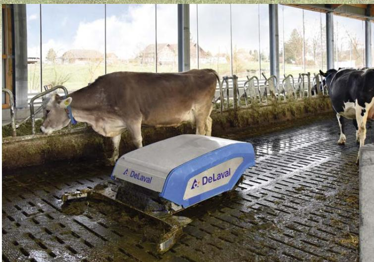
Der Entmistungsroboter RS450 sorgt für Sauberkeit im Stall. Er reinigt den kompletten, mit Spalten ausgestatteten Stall sowie den Laufhof ohne Spalten. Der RS450 arbeitet beinahe geräuschlos und in einer langsamen, kuhfreundlichen Geschwindigkeit.
