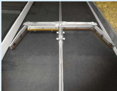
Der Delta Master wird in verschiedenen Bauhöhen von 16 cm, 20 cm und 28 cm produziert. Um die Reinigungsqualität des Klappschiebers zu erhöhen, gibt es neu die Möglichkeit, bestehende Schieber mit einem Gummilappen nachzurüsten (auch als Umbausatz für bestehende Anlagen verfügbar).
