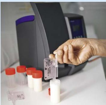
1. Mit der Analyse-kassette eine Milchprobe entnehmen (durch Drücken des Kolbens wird Milch aufgesogen).
