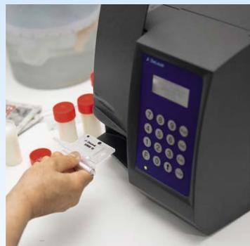
2. Mit der Taste (On/Off) das Gerät starten und die Kassette ins DCC einführen.
