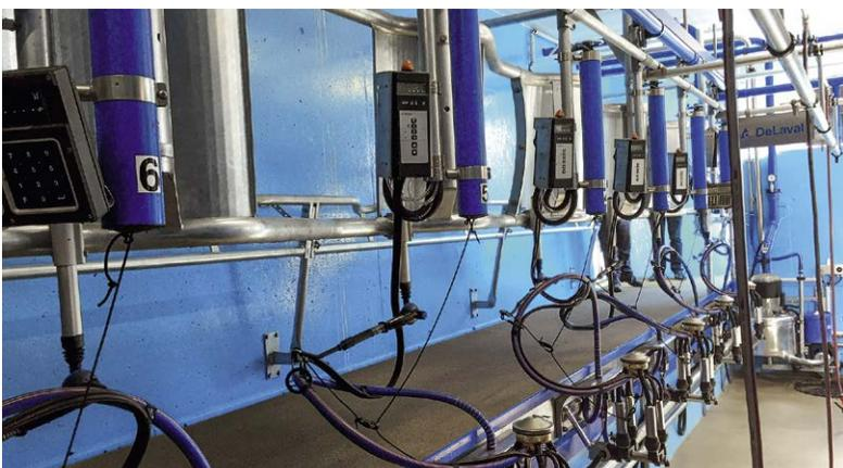
Der Melkstand ist mit dem Duovac System sowie Blut- und Leitfähigkeitsmessung ausgerüstet.
