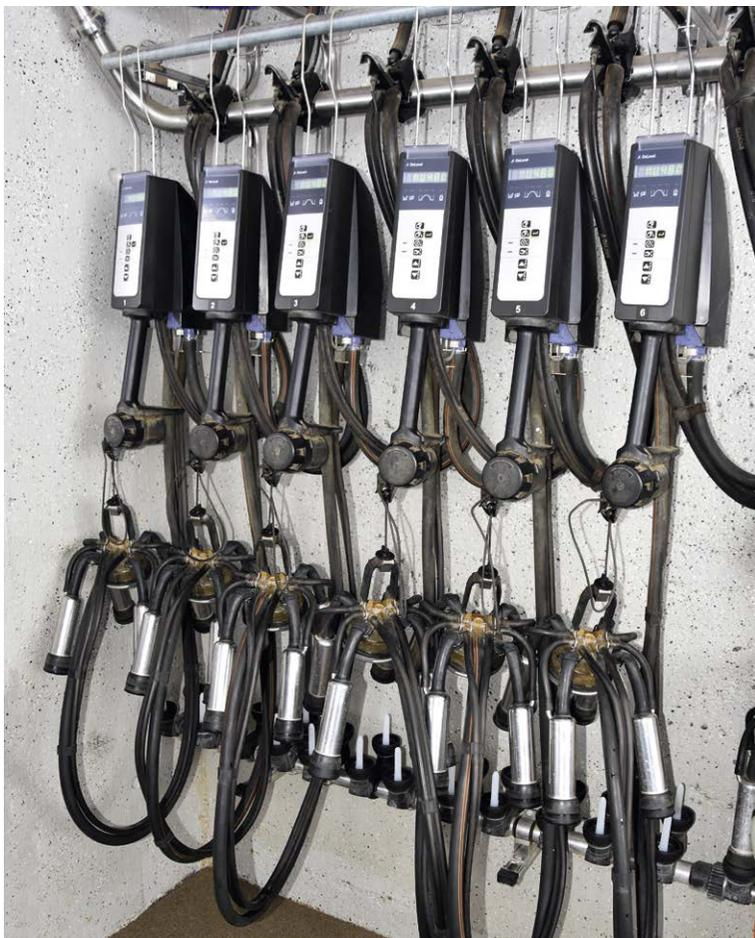
Familie Buchs melkt ihre Kühe mit der neuesten Technik für den Anbindestall. Die hochwertige Melkeinheit MU480 verfügt unter anderem über Vakuumstabilisierung, automatische Abnahme und anerkannte Milchmengenmessung.
