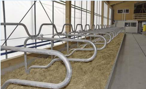
Das gebogene Nackenrohr ermöglicht der Kuh eine maximale Bewegungsfreiheit.
