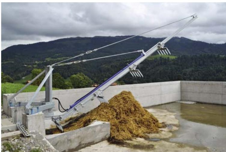
Der Hochförderer Circomat CH700 mit hydraulischem Antrieb: Dank seinem ruhigen Lauf und der einwandfreien Funktion hat er sich in Anbindställen sehr gut bewährt.
