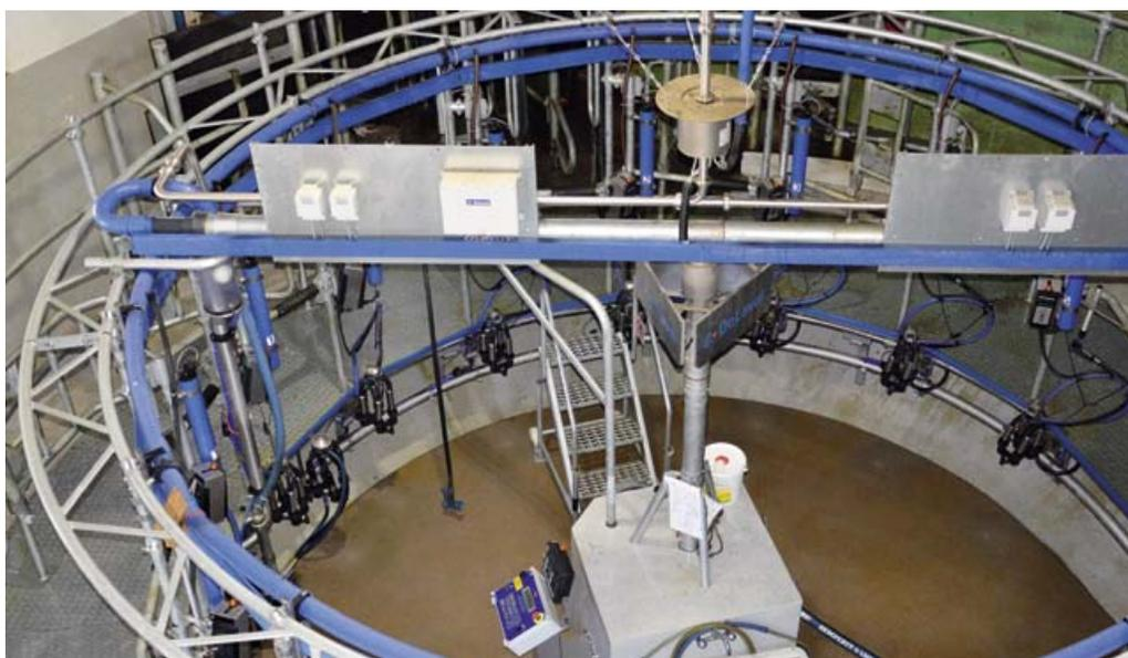
Der Melker steht im Innern des Karussells und kann so alle Melkplätze überwachen. Mittels der Drehkopplung können der Abtransport der Milch, die Vakuumversorgung und der Transport von Daten und Wasser gesteuert werden.
