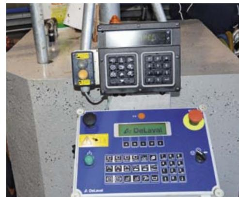
Die Bedieneinkonsole bestimmt die Drehgeschwindigkeit des Karussells. Das System analysiert die Daten von Melkgeschwindigkeit und Milchmenge jeder einzelnen Kuh.
