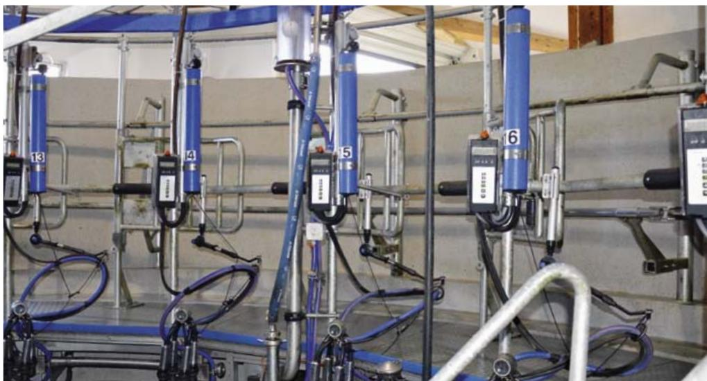
Die Melkplätze sind mit den Milchplatzcontrollern MPC580 ausgerüstet, welche über eine übersichtliche Anzeige verfügen.
