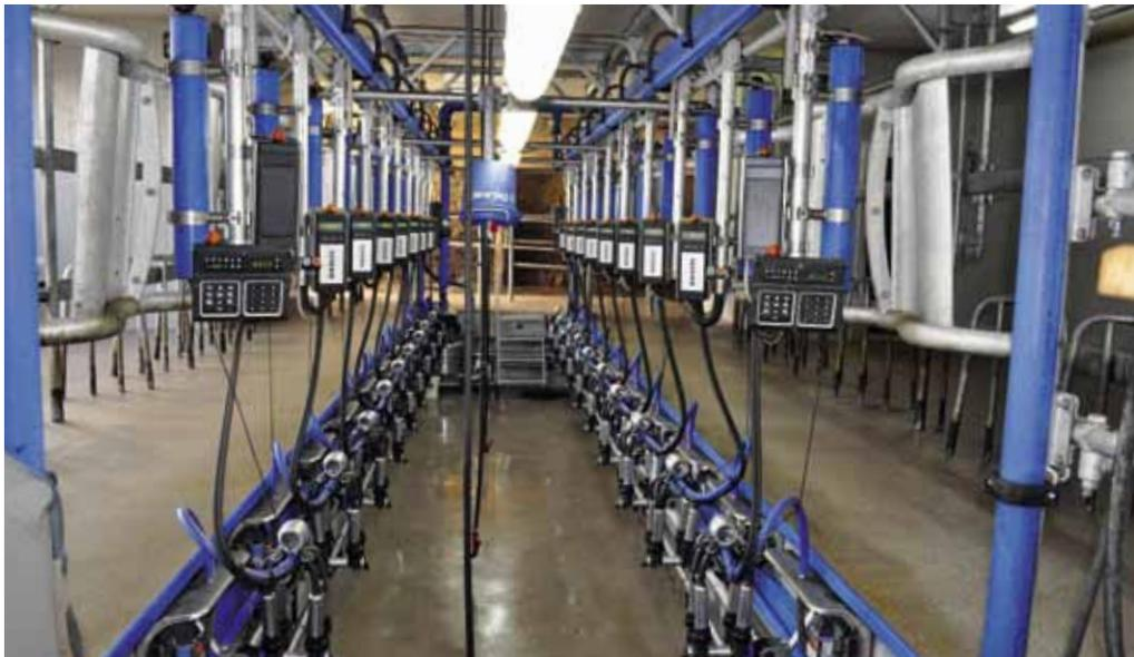
Ein grosser Melkstand für schnelle Durchtriebe: Es wurden 4 Melkplatzkontroller MPC680 und 16 MPC580 installiert.
