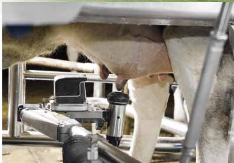
Der Vorbereitungsbecher für eine effiziente Zitzenreinigung und ein hervorragendes Stimulationsergebnis. Für einen schnellen Melkvorgang mit optimaler Milchflusskurve.
