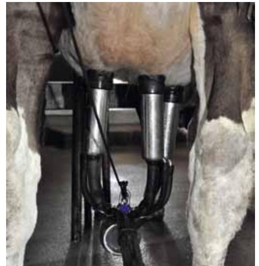
Das Melkzeug MC73 bietet Komfort für die Kuh und den Melker. Durch seine kompakte und ausbalancierte Formgebung liegt das Melkzeug gut in der Hand. Es wurde für höchsten Milchfluss konzipiert.
