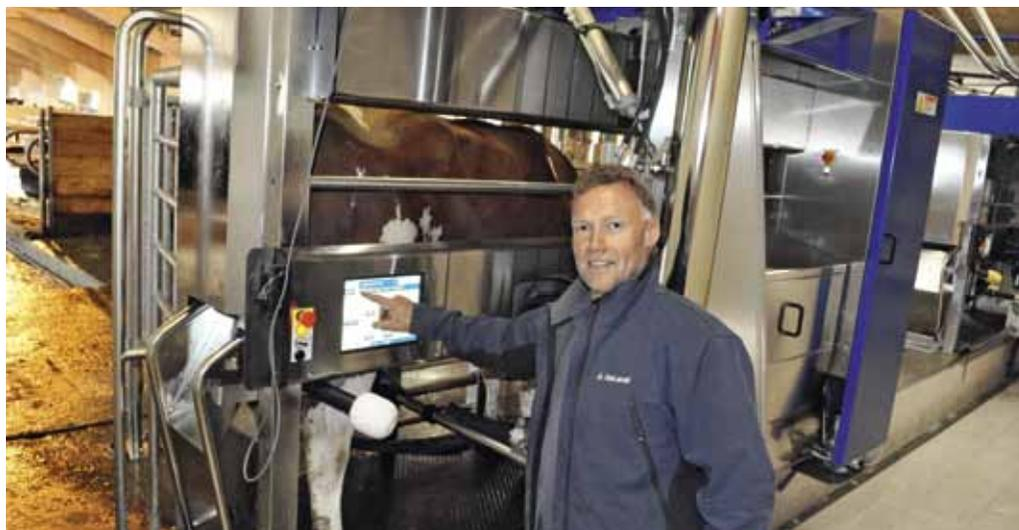
Komplett aus Edelstahl geformte Box. DeLaval steht für Langlebigkeit und Beständigkeit. Der Touch Screen Informationsbildschirm ist direkt beim Euter positioniert. Er bietet Zugang zu sämtlichen Überwachungsdaten jeder einzelnen Kuh.
