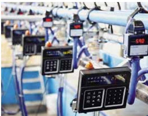
Das anerkannte Milchmengengerät **MM27BC** mit integrierter Qualitätskontrolle (Blut- und Leitfähigkeitsmessung) Modernste Technik für den Melkstand.
