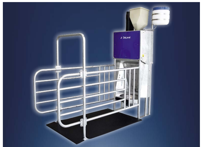
Kraftfutterstation von DeLaval: Gleitzeitfütterung und Dribbeldosierung sorgen für Ruhe im Stall.
