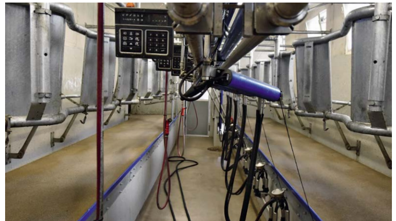
Fischgrätenmelkstand 30° MidiLine ML2100 mit Melkplatzcontrollern MPC680. Die Melkzeuge sind an einem freitragenden 2" Gerüst hoch im Melkstand montiert, in sauberer und trockener Umgebung. Benoît Maillard schätzt das ruhige und saubere Melken im neuen Melkstand.
