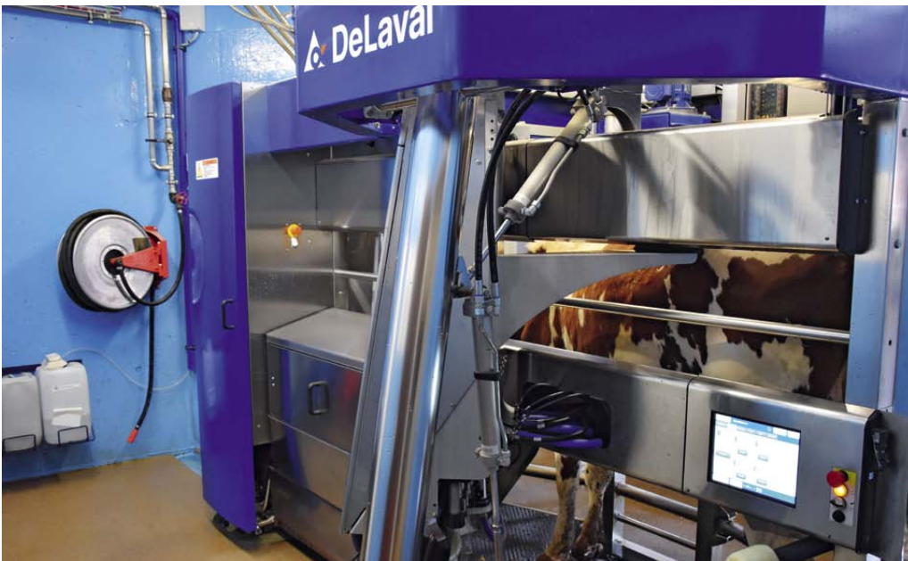
Grösstmögliche Hygiene beim VMS Melksystem: Der Zitzenreinigungsbecher und die Melkbecher werden nach jeder Kuh innen und aussen gespült und bleiben so absolut sauber.
