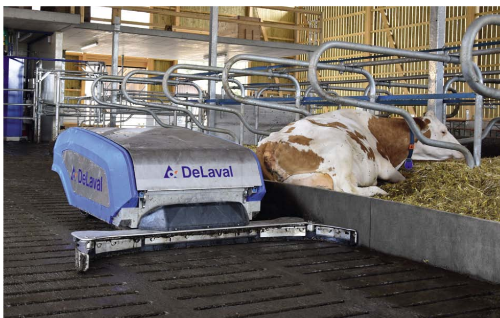
Der Spaltenroboter auf dem Betrieb Näf sorgt für saubere Oberflächen.
