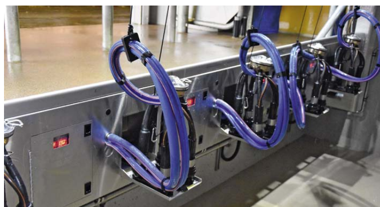
Sauber verpackte Technik für eine lange Lebensdauer. Die Milchmengenmessgeräte und Pulsatoren sind im Kabinett integriert.
