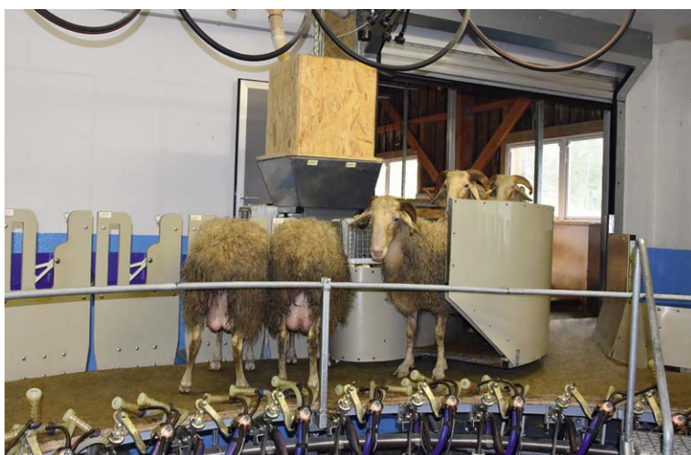
Dank der Positionierungshilfe beim Eingang sind die Schafe schnell in der richtigen Melkposition.
