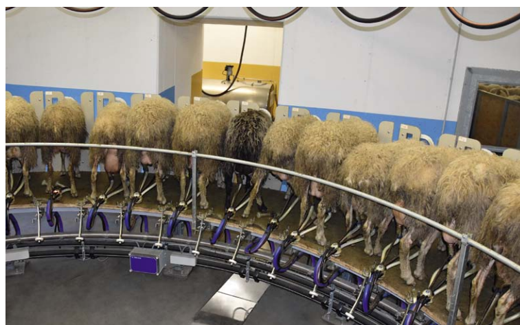
Das Sammelstück TF100 und die integrierte automatische Abnahme sorgen für einen einwandfreien Melkablauf.
