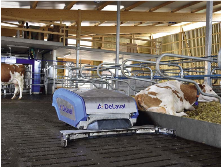
Der DeLaval Spaltenroboter ist in seiner Grösse und Stärke so ausgelegt, dass er in einer Runde grosse Flächen reinigen kann und dabei auch durch mögliche Tritte von Kühen nicht von seiner Route abgebracht wird. Durch das regelmässige Entfernen des Mistes von den Spalten wird die Sauberkeit der Laufgänge stark verbessert.
