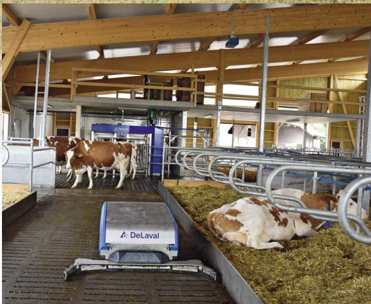
Der DeLaval Spaltenroboter ist in seiner Grösse und Stärke so ausgelegt, dass er in einer Runde grosse Flächen reinigen kann und dabei auch durch mögliche Tritte von Kühen nicht von seiner Route abgebracht wird. Durch das regelmässige Entfernen des Mistes von den Spalten wird die Sauberkeit der Laufgänge stark verbessert.
