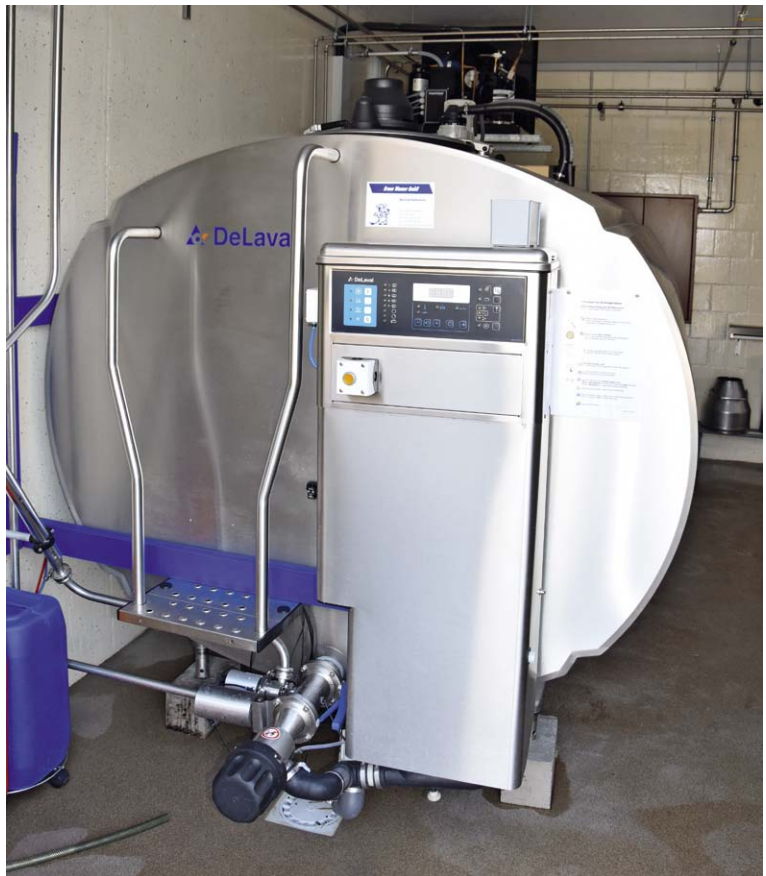
Der 5'000 l DeLaval Milchtank mit integriertem Reinigungsautomat sorgt für effiziente Kühlung und beste Lagerqualität.
