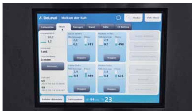
Touch Screen mit Anzeige der Milchmenge und des Milchflusses (Gesamt- und viertelindividuell). Ausserdem sichtbar: Zellzahlmessung und letzter Besuch im Melkroboter
