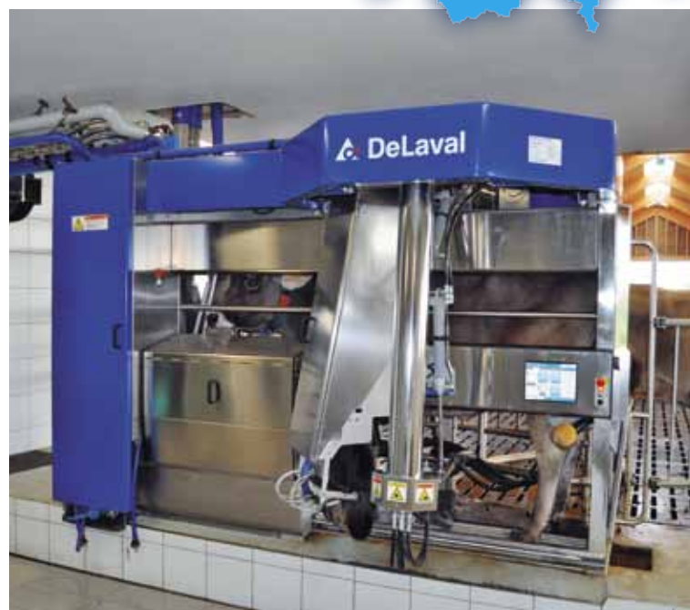
Der Melkroboter präsentiert sich als kompakte Box. Der Touch Screen ist am richtigen Ort. Der Roboter ist leicht erhöht, so ist die Bedienung und Betreuung des Systems einfach.
